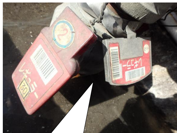
各注入口に油種バーコードを付け 色分けした油種バンドを設置
