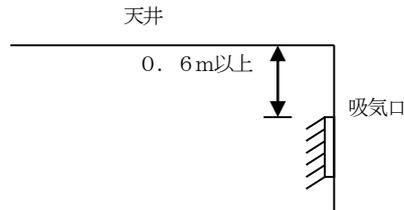
オ ア及びイにより吸気口付近に設ける場合は、吸気口から1.5m以内で、かつ、燃焼器等から漏れたガスを有効に検知できる方向に設けること。
