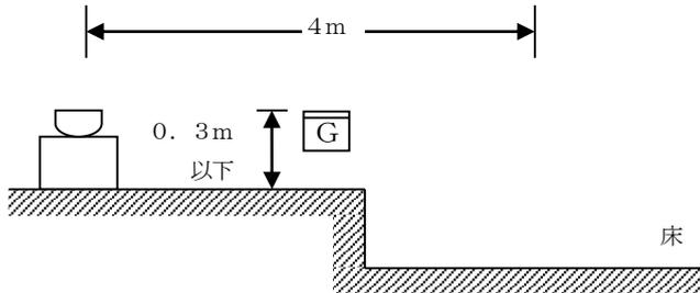
イ 燃焼器等又は貫通部から水平距離4m以内に床面から0.3mを超えるカウンター等がある場合は、燃焼器等又は貫通部側に設けること。(第25-15図参照)
