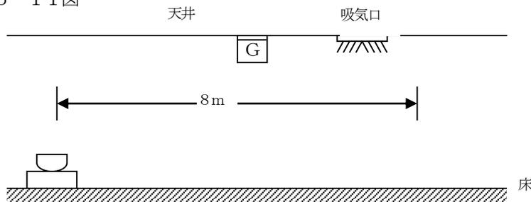
ウ 吸気口が0.6m以上突き出したはり等により燃焼器などから区画されている場合は、当該吸気口付近に設けないことができる。(第25-12図参照)
