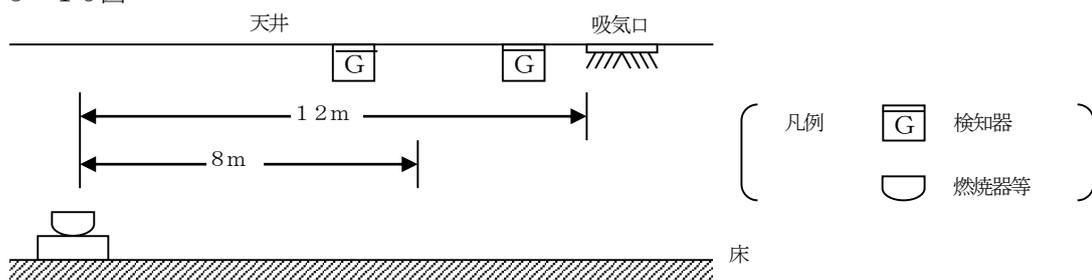
イ 燃焼器から水平距離8m以内に吸気口がある場合は、当該吸気口付近に設けることができる。（第25-11図参照）
